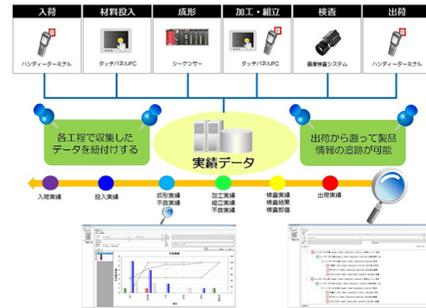
製造現場の各工程の工数情報と併せて、生産実績、検査実績、検査値などの情報もリアルタイムに収集できます。これらの情報を関連付けて一元化することで、出荷した製品から使用した材料のトレーサビリティ追跡を可能にします。
